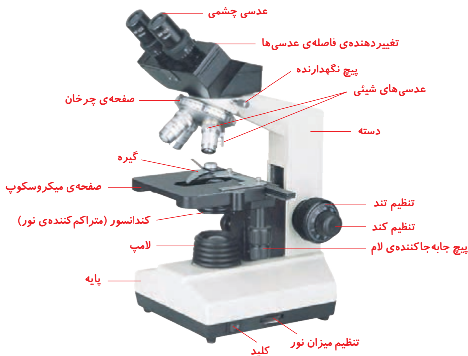
میکروسکوپ و اجزای آن
